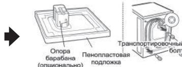
Снимите транспортировочные болты и опоры.
