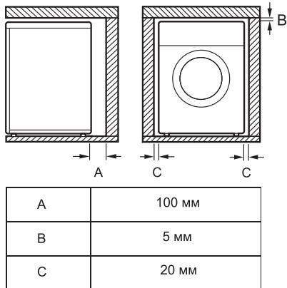
**Ровный пол:** допустимый уклон пола под всей занимаемой машиной площадью не должен превышать 1°.
