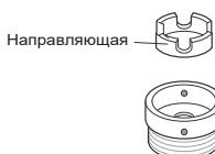
**3** Наденьте адаптер на конец крана так, чтобы резиновое уплотнение создало герметичное соединение. Затяните четыре крепежных винта и кольцевую пластину адаптера.
